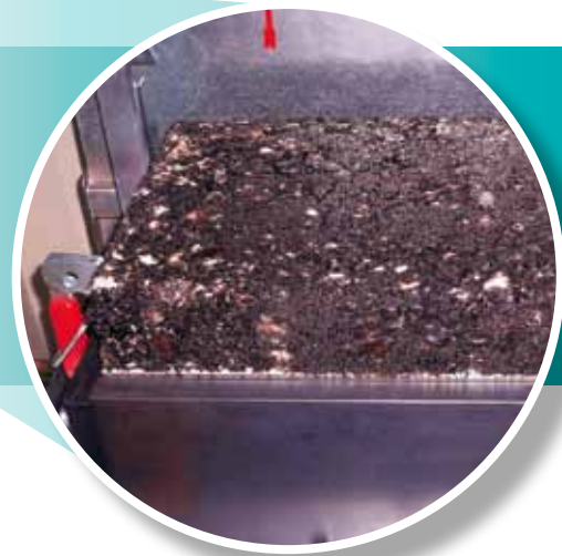
Asphaltprobe beim Entformen Asphalt sample moved upward for demoulding
